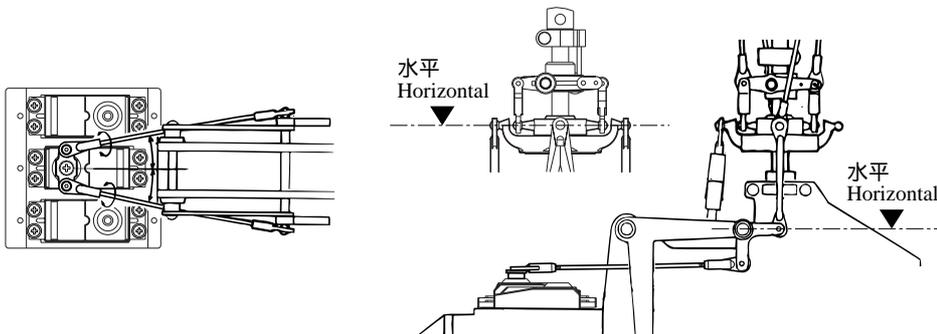
送信機のスティックとトリムがニュートラルの時、機体前方から見てスワッシュプレートが水平になるように、エルロンロッドの長さを調整してください。
