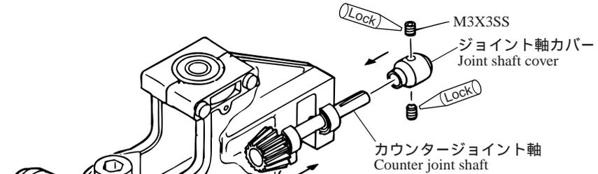
カウンタージョイント軸を矢印の方向へ一杯押しつけ、ガタを無くした状態でジョイント軸カバーを通し、Brg. に接触する位置に合わせます。
