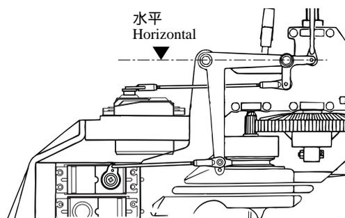
送信機のスティックとトリムがニュートラルのとき、コレクティブピッチレバーが水平になるようにコレクティブピッチロッドの長さを調整してください。
