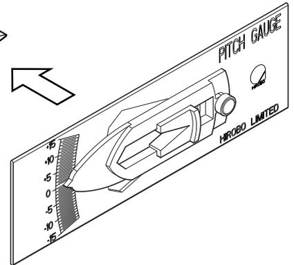
2. 送信機のスロットルスティックを動かし、スタビライザーとピッチゲージを平行にし、指された目盛りを読んでください。測定するときは実際に飛行しているときのようにメインブレードの先端を軽く持ち上げて測るとより正確に測れます。
