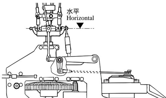
送信機のスティックとトリムがニュートラルのとき、機体側面から見てスワッシュプレートが水平になるようにエレベーターロッドの長さを調整してください。
