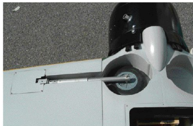
メインギヤ取付け例 Attachment example of main gear
