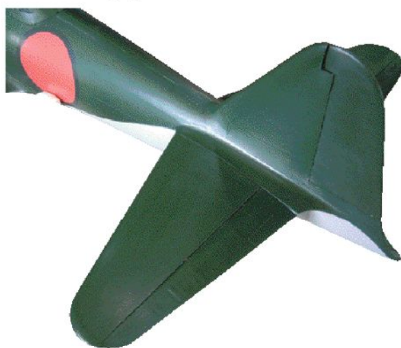
水平尾翼、エレベーター取付け例 Attachment example of horizontal stabilizers and elevators
