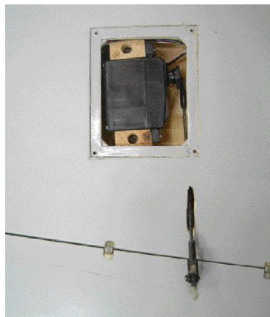
フラップサーボ取付け、リンケージ例 Flap Example of servo attachment and linkage
