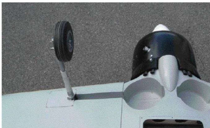
メインギヤ取付け例 Attachment example of main gear
