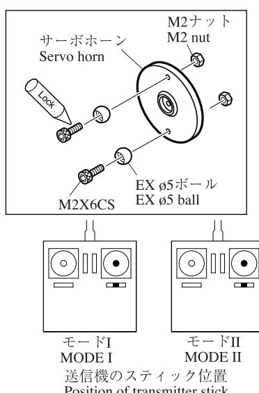
送信機のスティックがニュートラルでトリムがニュートラルの時、右の図のようになるようにロッドの長さを調整します。
