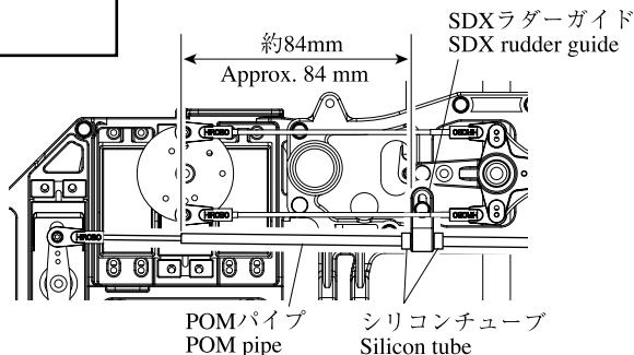
SDX ラダーガイドの両側に5mm程の長さにカットしたシリコンチューブをはめて固定します。
