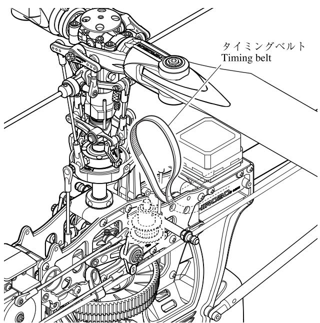
組み立てるときは、タイミングベルトの回転方向及びねじれに注意してください。(P.27を参照)
