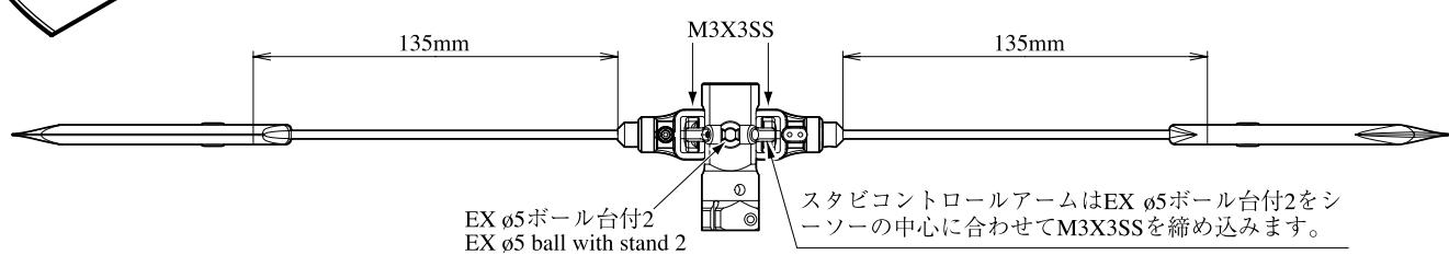
スタビコントロールアームはEX φ5ボール台付2をシーソーの中心に合わせてM3X3SSを締め込みます。
