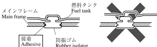
防振ゴムとフレームは凹凸部を合わせ、瞬間接着剤で接着してください。
