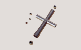
十字レンチ ナットサイズは、7ミリ、5.5ミリ、4.5ミリ、4ミリの対応の ものに対応しています。
