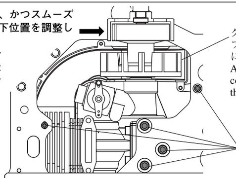
クーリングファンがクーリングファンカバーに接触しないように上下の位置を調整します。
