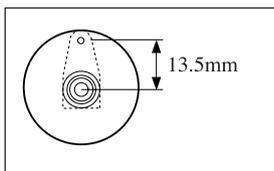
送信機のエンジンコントロールスティックとそのトリムがニュートラルのとき、キャブレット本体のホバリング目印とキャブレットローターの目印が一致するようにロッドの長さを調整して下さい。
