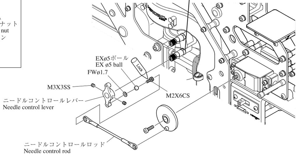
送信機のボリューム（空きチャンネル）を使用した場合、ボリュームがニュートラルの時、ニードルの中心とサーボホーンを中心を結ぶ線に対して、ボールが直行するようにサーボホーンを取り付け、ニードルコントロールレバーが直行するようにロッドの長さを調整して下さい。
