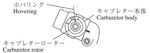
ロッドの長さを調整したらスティックを動かして、全開と全閉の位置を送信機の舵角調整機能で調整して下さい。
