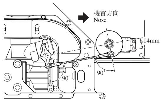
ニードルの開度は使用するエンジン、マフラー、燃料によって異なります。エンジンなどの取扱説明書を参考に調整して下さい。
