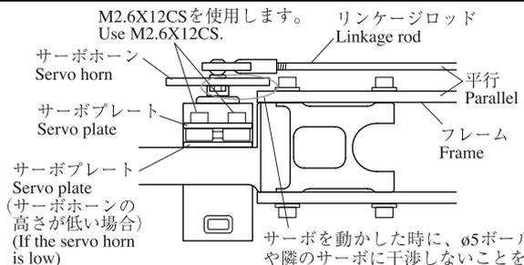
サーボを動かした時に、ø5ボールを止めるネジやナットがフレームや隣のサーボに干渉しないことを確認します。
