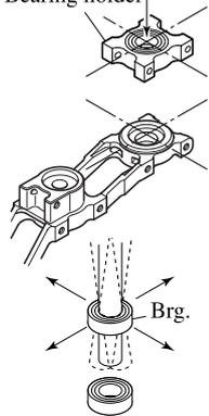
完全にネジ締めする前に、調整が必要です。左図の様にメインマストをBrgホルダーに組み込んでBrgホルダーのBrg位置がマストに対し、同軸上にある位置に調整をします。
