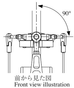
送信機のスティックがニュートラルでトリムがニュートラルの時、右の図のようになるようにロッドの長さを調整します。
