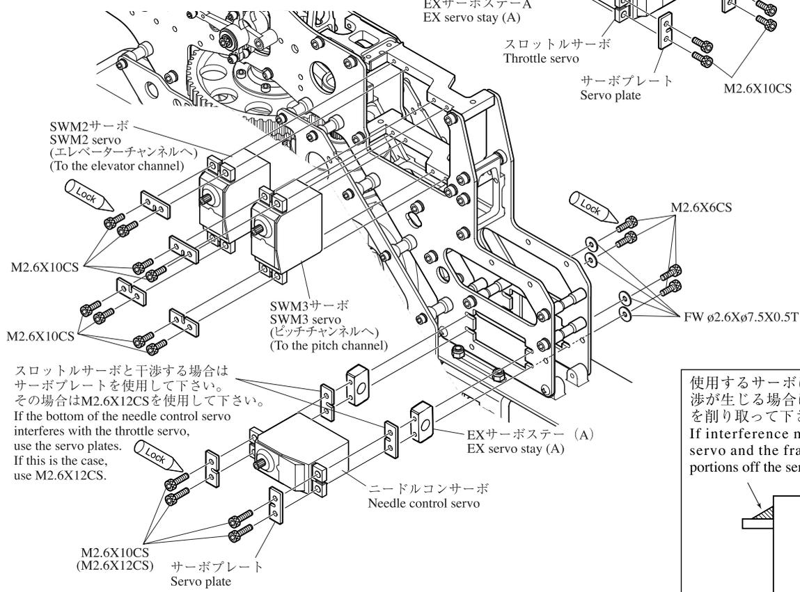
使用するサーボによってフレームと干渉が生じる場合は、サーボの下図部分を削り取って下さい。
