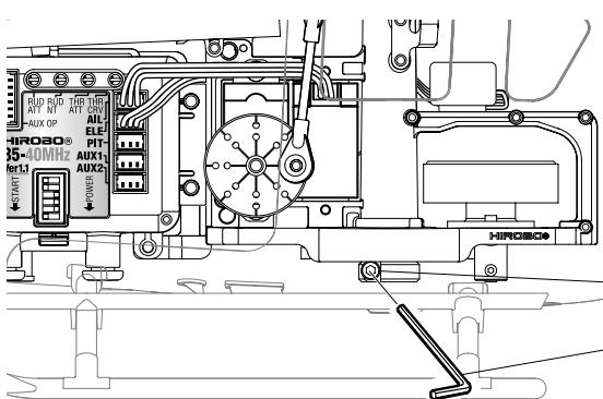
メインギヤをメインマストに固定しているキャップスクリューM2X6が緩んでくると、メインギヤが空回りし、モーターのパワーを伝達できなくなります。すると、スティックの動きに応じた機体の上昇ができなくなります。ネジが締まっているかどうか確認しましょう。
