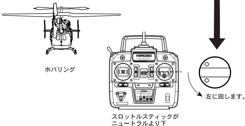
ホバリングでの送信機スロットルスティック位置がニュートラルより上の場合、THR CRV（スロットルカーブ）調整ボリュームを右に回します。
