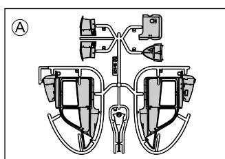
ⒶⒷⒸパーツのアミガケ部分の内側を塗ると良いでしょう。表面や接着面に塗料が付かないようにマスキングを行ってから作業してください。
