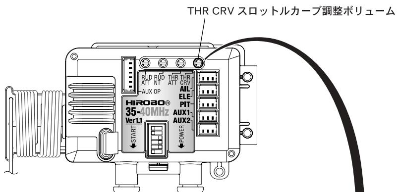
ホバリングでの送信機スロットルスティック位置がニュートラルより下の場合、THR CRV（スロットルカーブ）調整ボリュームを左に回します。
