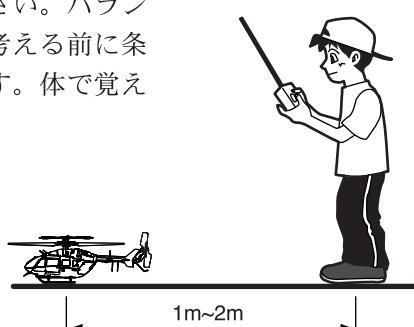
機体を平らな床の上に置きます。操縦者は機体の後方1~2mの位置に立ってください。
