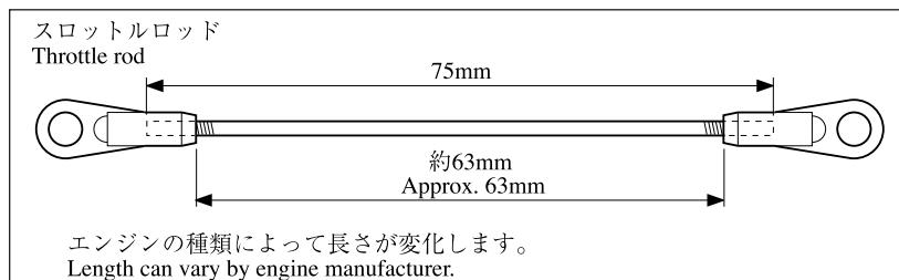
(1) 送信機のスティックが中立のとき、図のような位置関係になる様にサーボホーン及びスロットルロッドを調整します。
