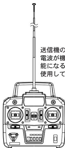
送信機のアンテナをのばしていないと、電波が機体まで届かず、コントロール不能になる恐れがあります。必ずのばして使用してください。
