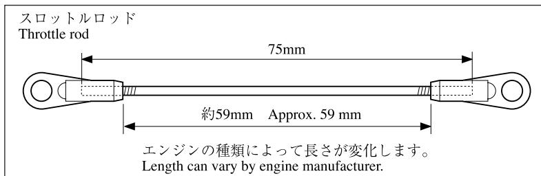
(1) 送信機のスティックが中立のとき、図のような位置関係になる様にサーボホーン及びスロットルロッドを調整します。
