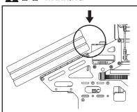
バッテリーを機体に搭載するときは、バッテリーがモーターに接触しないように搭載してください。
